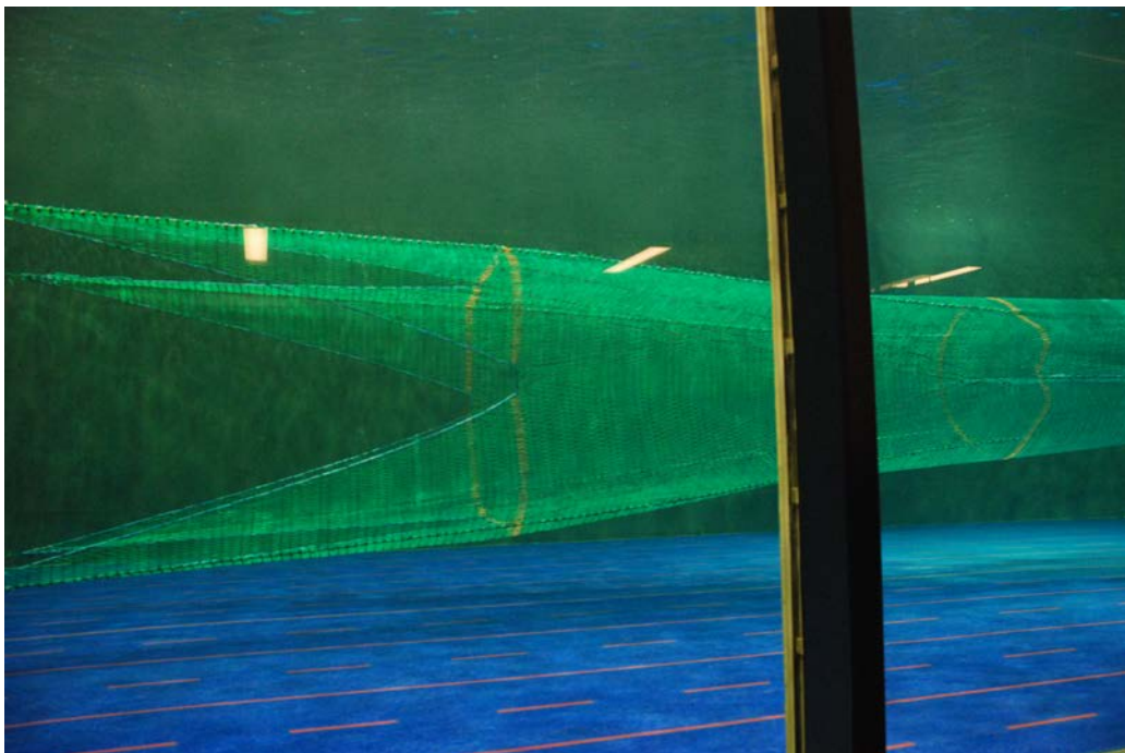
Bilde 6. Forpart av skillepanel uten ledene, men med tre tau opp, og tre tau ned fra skillepanel. Skillepanel deler spesialforlengelsen i tilnærmet to like halvdel.
